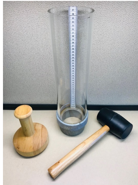
(d) Modified Philip-Dunne infiltrometer.
