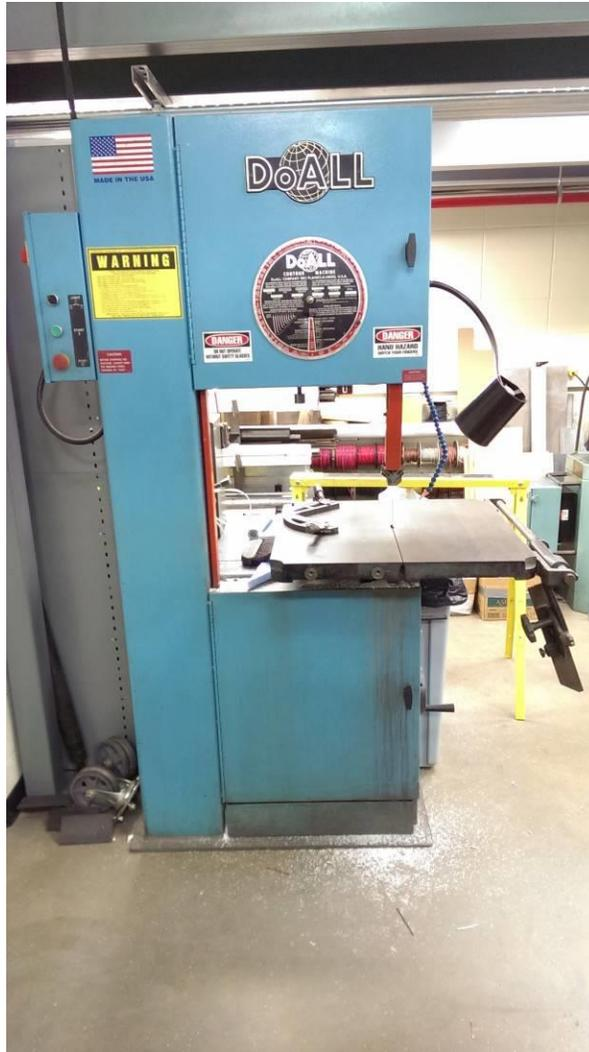
**Figure 22. Do-All Vertical Band Saw**
