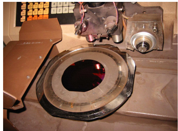
(d) Wafer mounted for dicing
