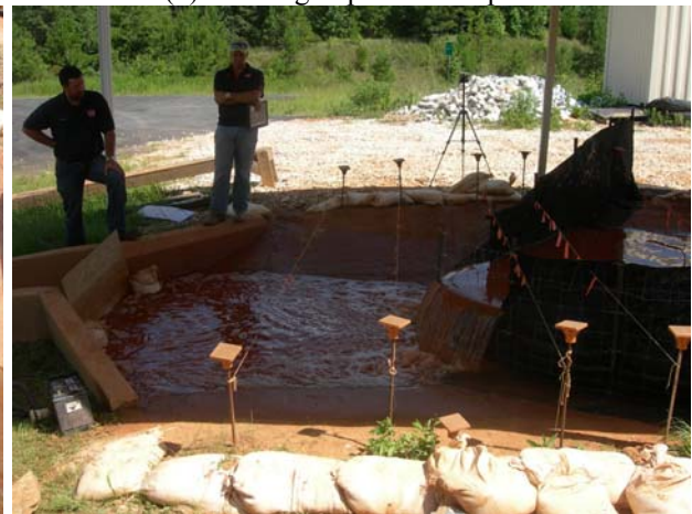
(d) demonstration of downstream subcritical pool
