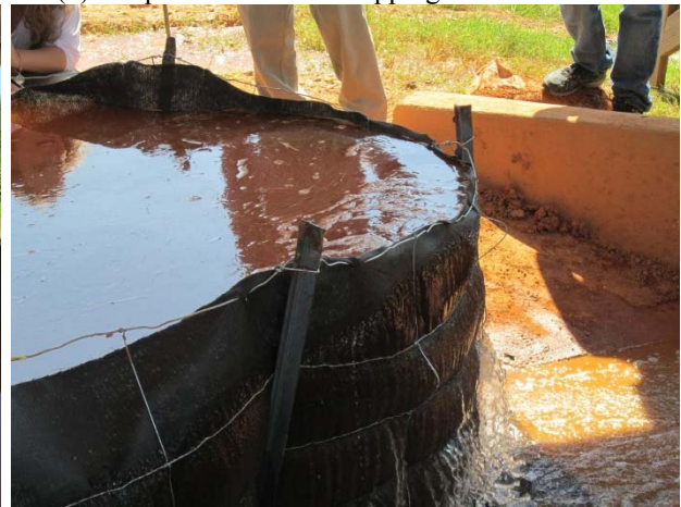
(d) silt fence full pool depth
