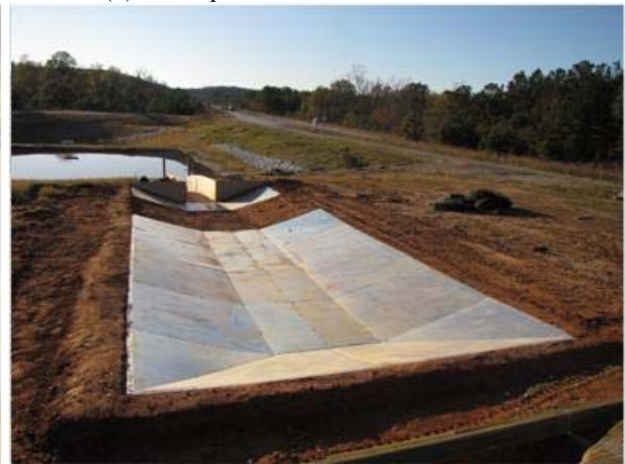
(d) berm and drain around channel prototype
