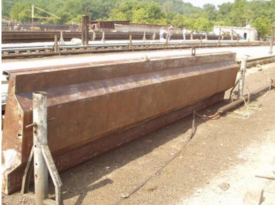
Figure B-58: AASTHO type IV forms used
